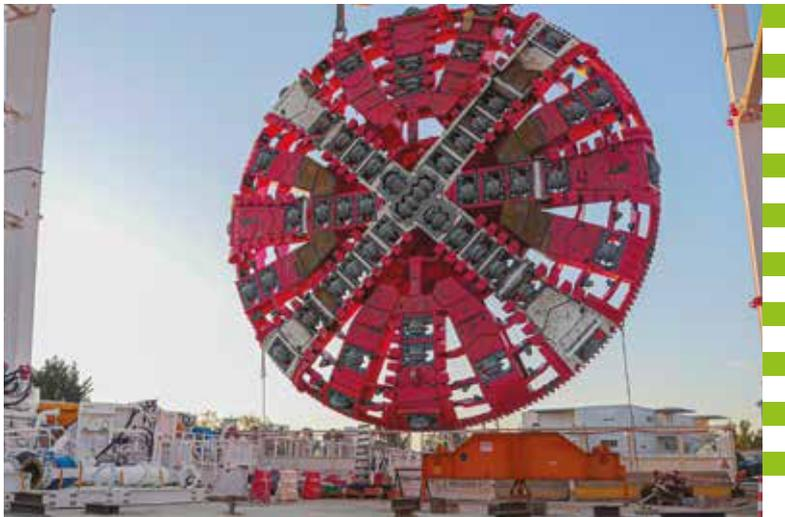
Roue de coupe du tunnelier de l'extension du métro B jusqu'à Gare d'Oullins
